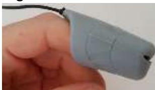
Der Pulsmesser wird auf den Zeigefinger gesteckt. Die verwendete Hand sollte keine Elektrode halten, um eine entspannte Handhaltung zu ermöglichen. Der innenliegende Messknopf muss guten Hautkontakt haben. Der Finger sollte die Kappenspitze nicht berühren und den Schlitz nur wenig aufdehnen.
