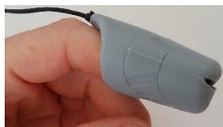
Der Pulsmesser wird auf den Zeigefinger gesteckt. Die verwendete Hand sollte keine Trikombin-Elektrode halten, um eine entspannte Handhaltung zu ermöglichen. Der innenliegende Messknopf muss guten Hautkontakt haben. Der Finger sollte die Kappenspitze nicht berühren und den Schlitz nur wenig aufdehnen.
