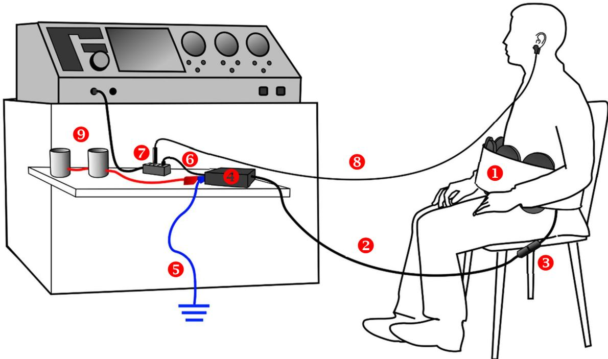
1. Der Gürtel (1) wird mit dem Verlängerungskabel (2) verbunden. Der Stecker (3) rastet ein und kann nur wieder gelöst werden, wenn der seitliche Knopf beim Herausziehen gedrückt wird.
