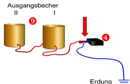
**Achtung:** Werden die Becher *zwischen* Antenne und Erdungskabel angeschlossen, entsteht ein Wirkungsverlust der Antenne!
